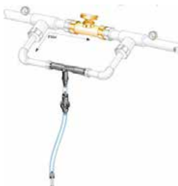
Injector parallel aan de hoofdstroom geplaatst
