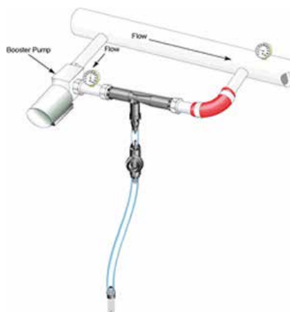
Injector in combinatie met een pomp waardoor een drukverschil gecreëerd wordt
